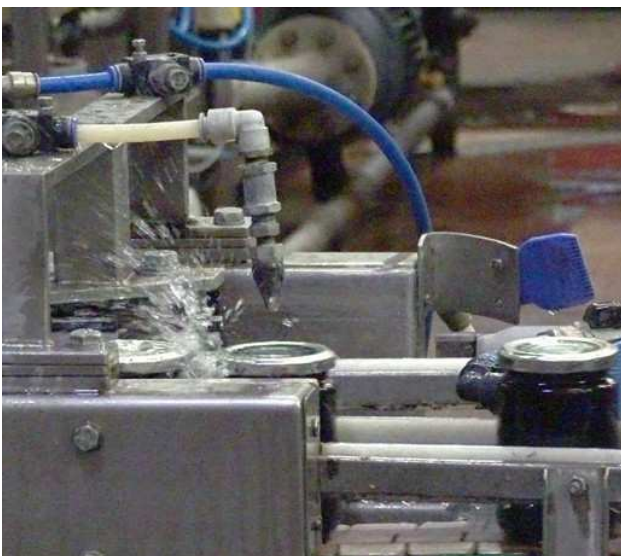
Vzduchové trysky při sušení sklenic před přilepením etikety.
